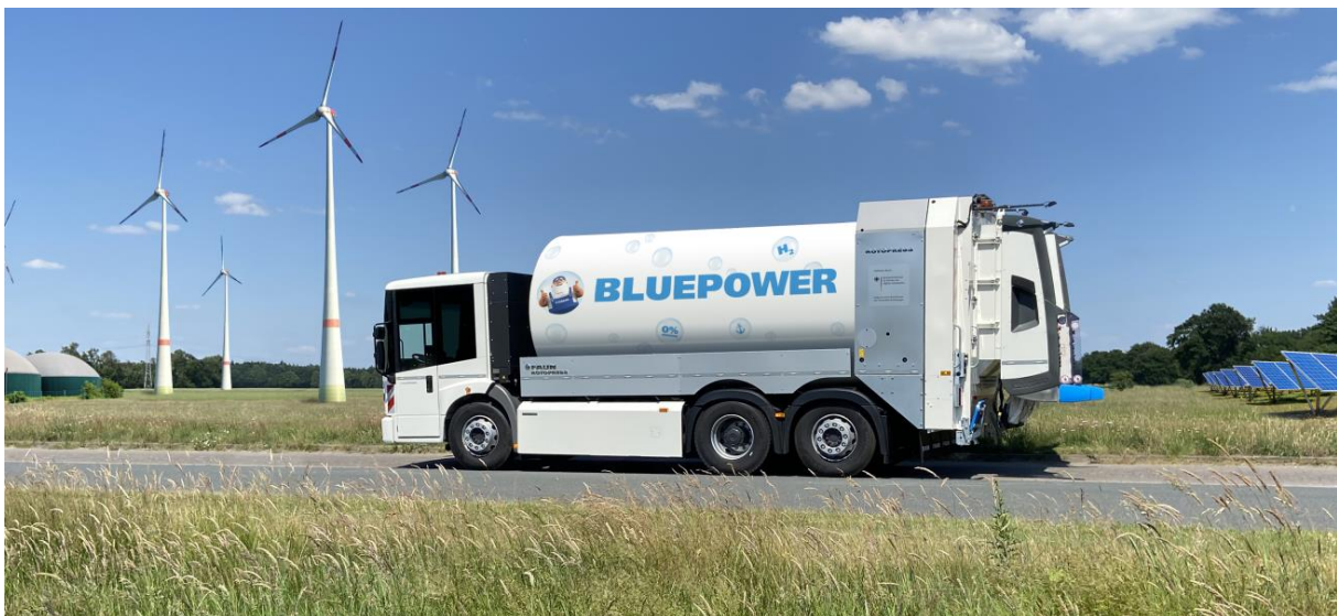
Abbildung 26 Nutzfahrzeuge mit Wasserstoffantrieb (BLUEPOWER von Faun
